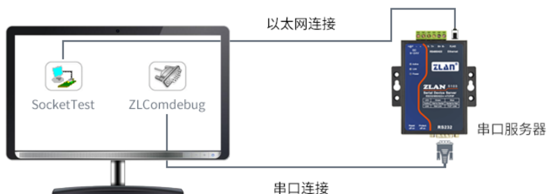
图 17 TCP 通讯示意图
